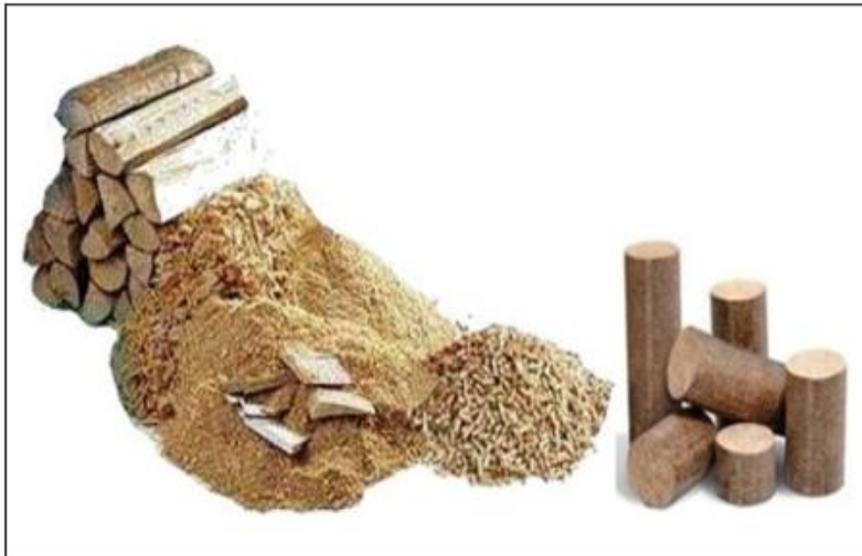
Slika 1 Les kot gorivo v obliki polen, sekancev, skoblancev, žagovine, lesnih odpadkov, pelet in briketov. Vir: spletne strani
